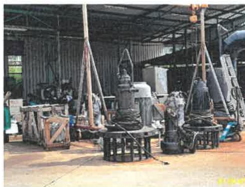
ภาพที่ 2.2-23 เครื่องสูบน้ำสำรอง
